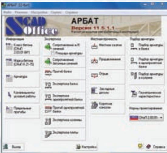
Выполняется подбор арматуры в многопролетных балках постоянного сечения (прямоугольного, таврового или двутаврового) и в колоннах (прямоугольного, таврового или кольцевого сечений) по предельным состояниям первой и второй группы (прочность и трещиностойкость). Рассматривается плоская работа балки, а также плоская и пространственная работа колонны.
